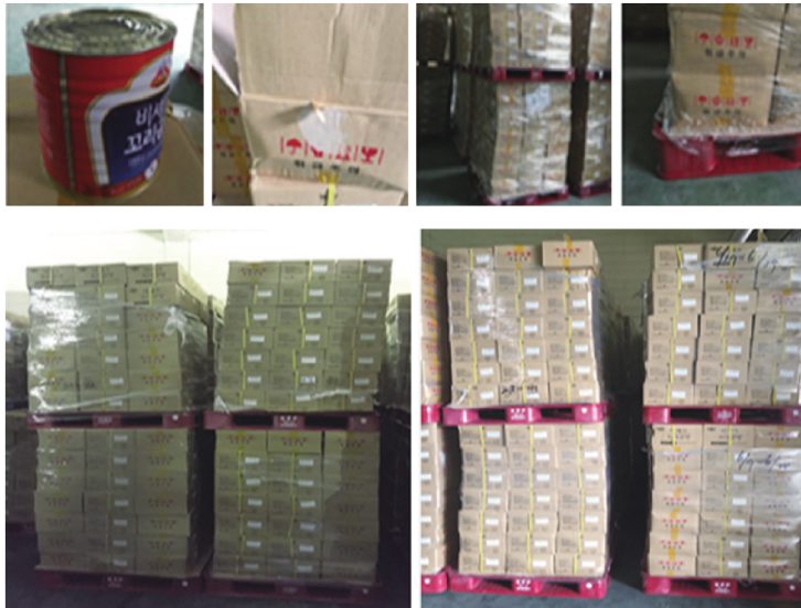
그림 31. 편심하중 발생 적재 형태와 이로 인한 제품 파손
