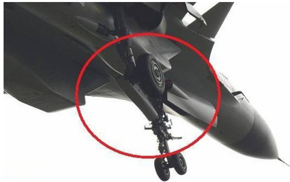
그림 3-8 | 항공모함 운용을 위해 개조한 것으로 추정되는 J-15 nose gear 형상
