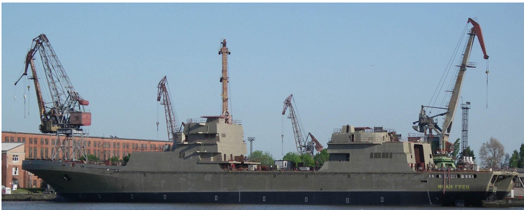
그림 5-4 | 진수 후 의장 공사 중인 러시아의 Ivan Gren급 상륙강습함
