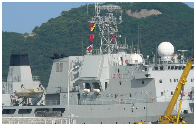
그림 3-20 | 중국의 052D식 구축함에 탑재된 평면위상배열 레이더
