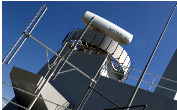
그림 4-5 | 퀸엘리자베스함에 설치되는 Type 997 Artisan 3차원 중거리 탐지 레이더
