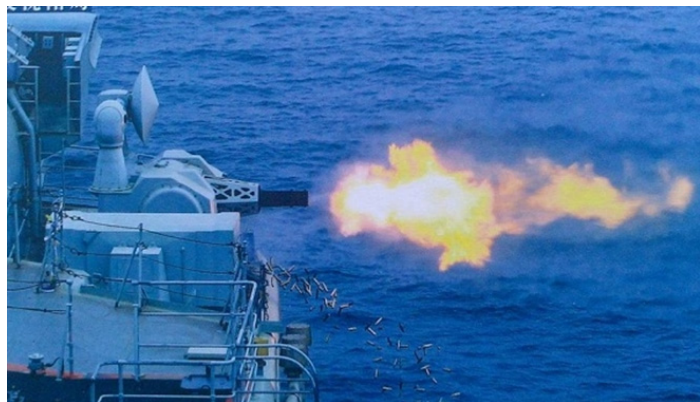
그림 3-9 | 랴오닝 함 탑재 HPJ14(1130 식) 근접방어시스템 시험 모습
