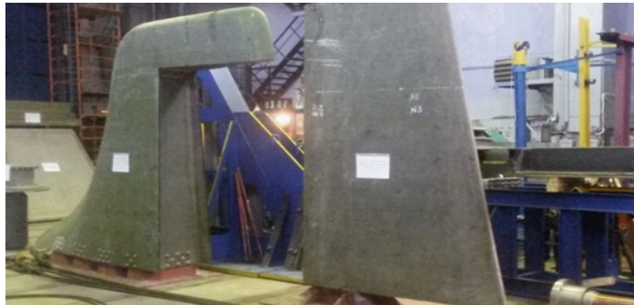
| 그림 5-33 | 다중적층복합소재로 제작한 라다급 잠수함의 키날개
