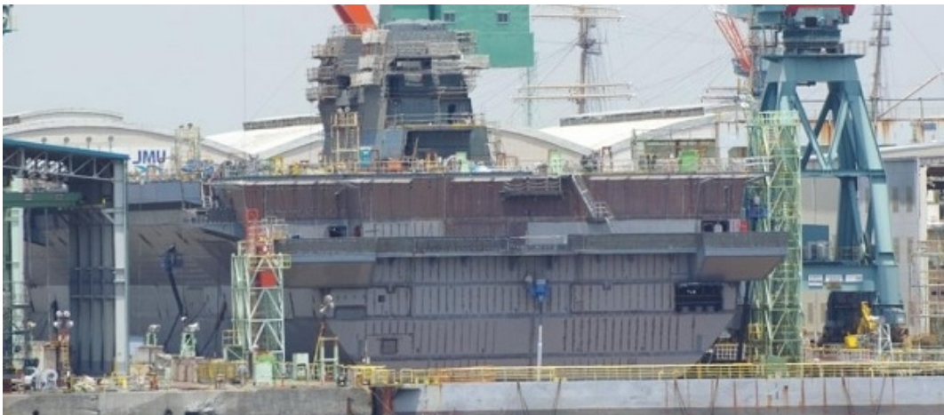
| 그림 8-3 | 이즈모급 구축함 2번함 선체에 함교가 장착된 모습
