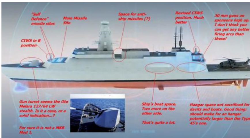
그림 4-14 | Type 26 GCS의 시스템 배치 개략도(예상)
