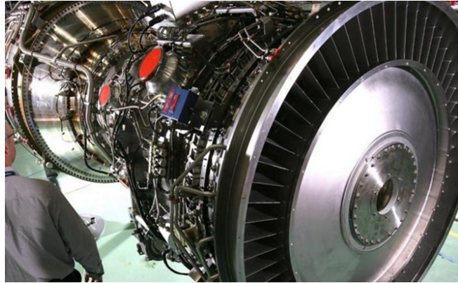
그림 4-13 | Type 26에 탑재될 롤스로이스사의 MT30 가스터빈
