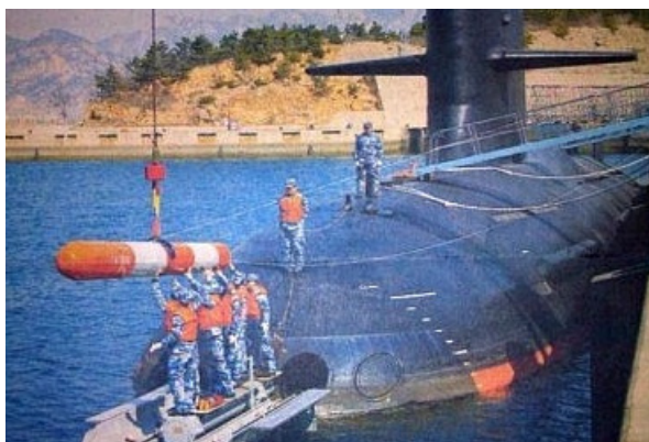
그림 3-37 | 순항미사일을 탑재 중인 093B식 원자력추진잠수함
