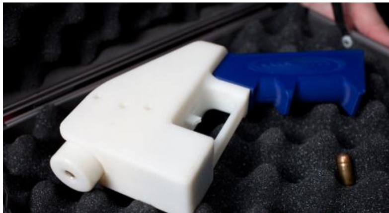
그림 3-59 3D 기술로 제작되어 시험발사에 성공한 권총
