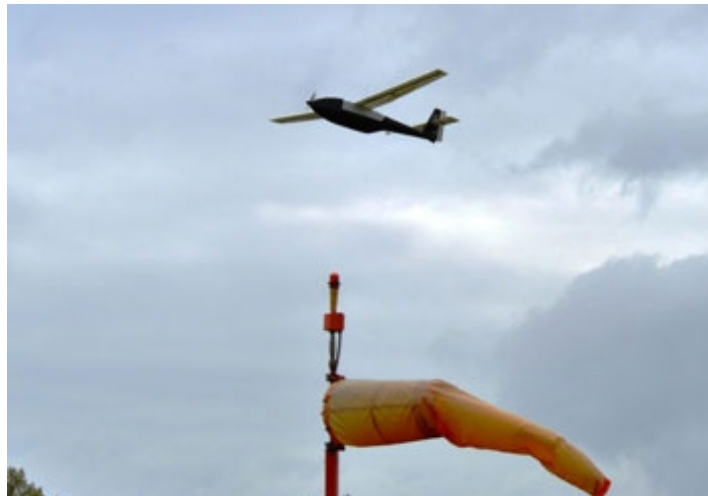
그림 3-36 액화수소 연료를 이용한 Ion Tiger 무인기의 비행 모습
