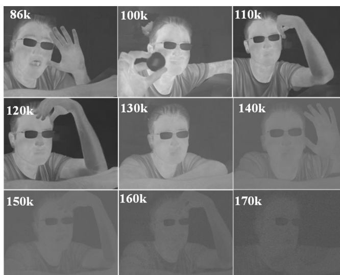
그림 3-25 T2SL 소자를 이용한 온도별 중파적외선 영상
