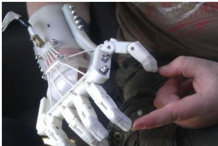
그림 3-61 3D 프린터로 제작한 손가락 보조장치 ‘RoboHands’
