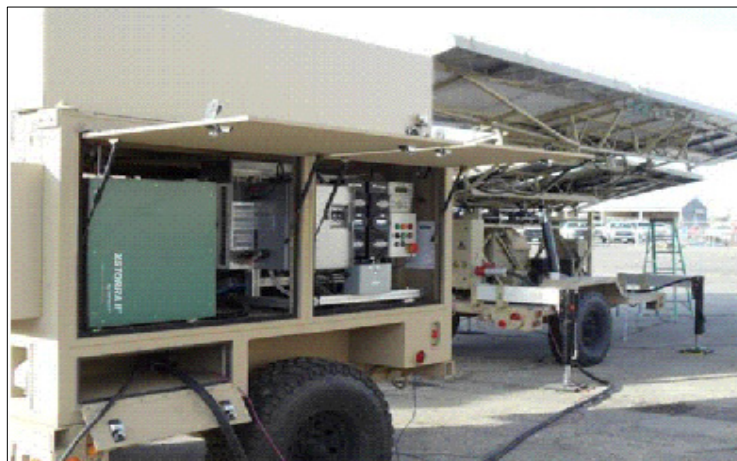
그림 3-65 트레일러 장착 재생연료전지 시스템(미 해군)
