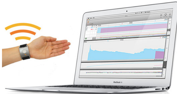
그림 3-11 사람의 스트레스 수준을 측정하는 'Q-센서'
