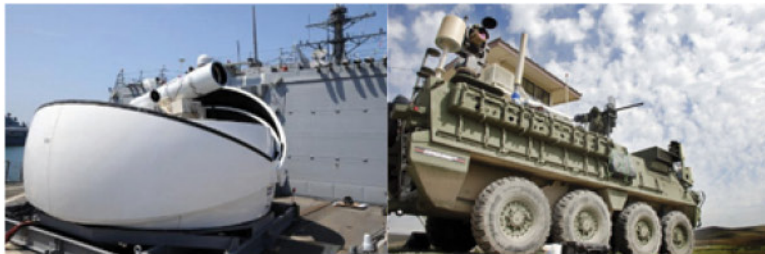
그림 1 상륙함 탑재 30kW 레이저 무기시스템(좌), 통합 시험 중인 스트라이커 장갑차 탑재 5kW급 레이저 무기시스템(우)
