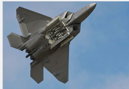
그림 4 F-22 랩터 전투기에 부착된 LAU-142/A
