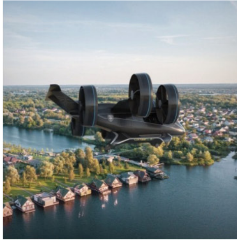
그림 9 벨사의 넥서스(Nexus) 항공기에 적용될 사프란사의 하이브리드-전기 분산 추진체계(사진 제공: 벨헬리콥터사)
