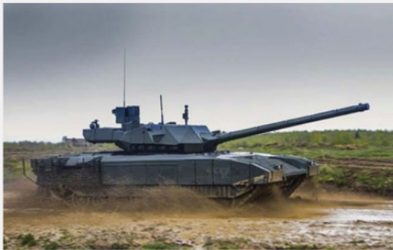
그림 5 말라히트 ERA가 설치된 T-14 아르마타 MBT
