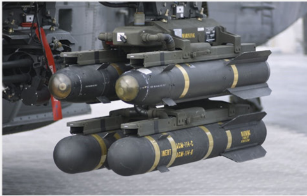
그림 5 AGM-114 헬파이어(Hellfire) 미사일과 호환 가능한 M299 롱보우(Longbow) 미사일 발사대
