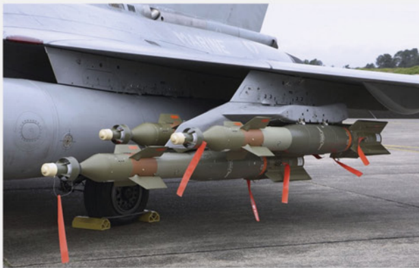
그림 2 라팔 다목적 전투기용으로 특별히 설계된 AT730 삼중 랙
