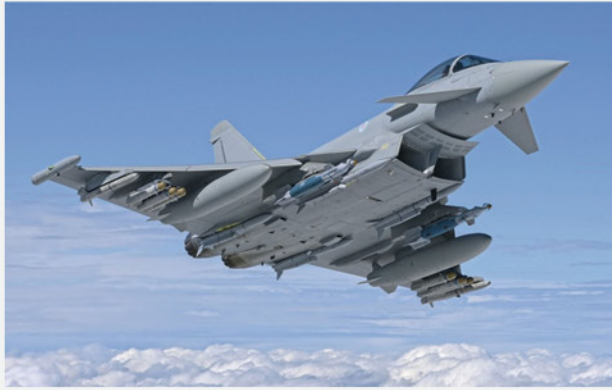
그림 1 AGM-129 삼중 레일형 발사대를 통해 타이푼 전투기에 탑재된 브림스톤 2 정밀공격 미사일
