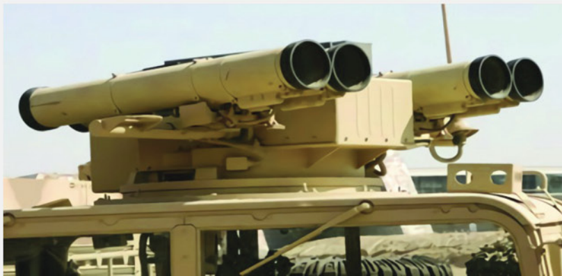
그림 1 크버르테트(Kvartet) 포탑에 코넷 ATGW 발사관
