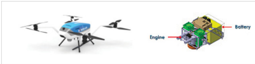
그림 14 KUS-HD 형상 및 하이브리드 엔진 구조
