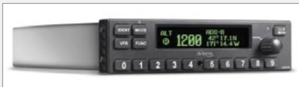
그림 1 ADS-B Out 체계를 갖춘 APX340 모드 S 트랜스폰더
