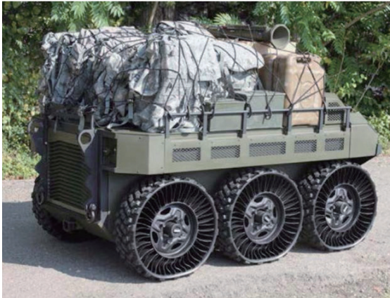
그림 2 HDT사의 헌터 울프 플랫폼(타이어와 휠을 일체화한 무공기 타이어 미쉐린 트윙클을 장착)
