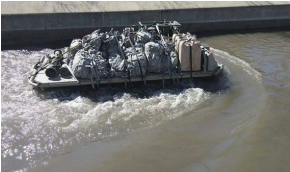
그림 11 완전한 수륙양용 기능을 구비한 MUTT UGV(타이어 트레드 특수설계로 수중에서 추진)
