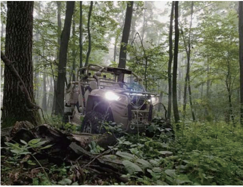
그림 3 유무인 겸용이 가능한 MRZR X 플랫폼(폴라리스사의 4인승 MRZR 차량에 기반)
