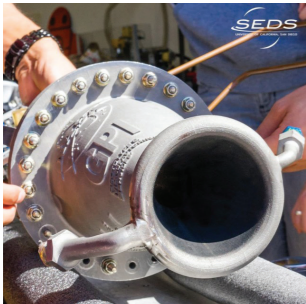
그림 3 3D 프린팅 볼칸-1 로켓
