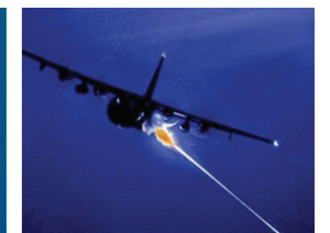
그림 6 AC-130에서 150kW 레이저 시험
