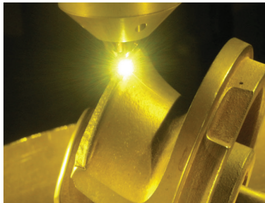
그림 2 DED 방식 3D 프린팅
