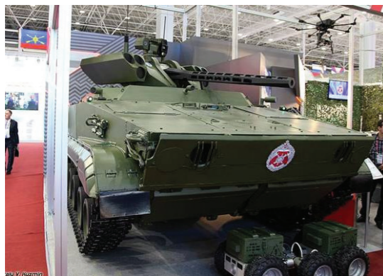
그림 4 BMP-3 보병전투장갑차를 개조한 러시아 비키르 UGV
