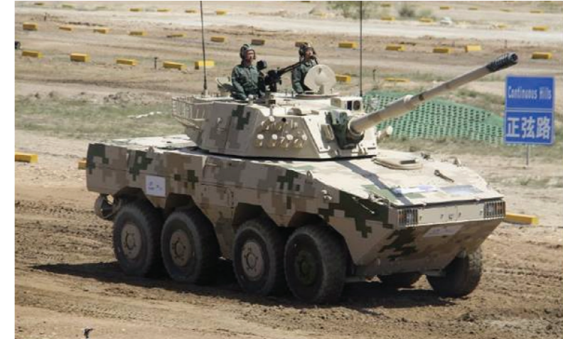
좌측에 포수, 우측에 차량장이 위치하고, 105mm 강선포는 배연기와 일자형으로 흡이 난 포구제퇴기를 장착한 노린코 ST1 WTDV
