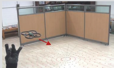
이태운 연세대 전기전자공학부 교수팀이 개발한 스마트 섬유를 이용해 만든 장갑. 손모양에 따라 드론이 지정된 명령을 수행하도록 했다. (출처: 연세대 전기전자공학부)
