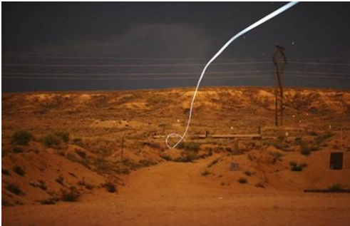
| 그림 1 | Sandia 국립연구소 연구원들이 자체유도 50mm 추진체 표적획득 체계를 개발하였으며, 본체계는 비행경로를 조정함으로써 거리에 따라 정확도를 개선
