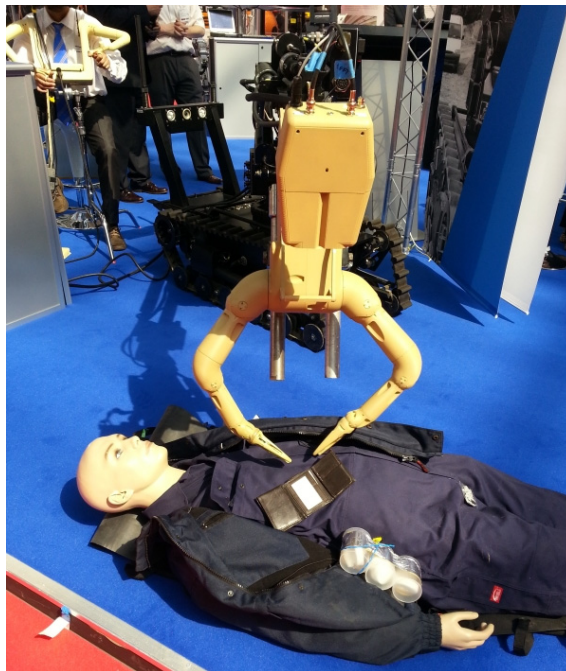
| 그림 1 | 노드롭그루먼사의 Lobster 로봇 : 매우 정교한 한 쌍의 매니플레이터로 누워 있는 사람 주머니에서 물건을 꺼낼 수 있다.
