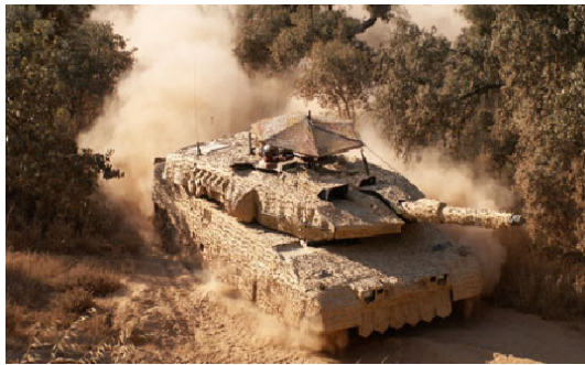
| 그림 11 | Saab사의 Barracuda 이동형 위장 시스템
