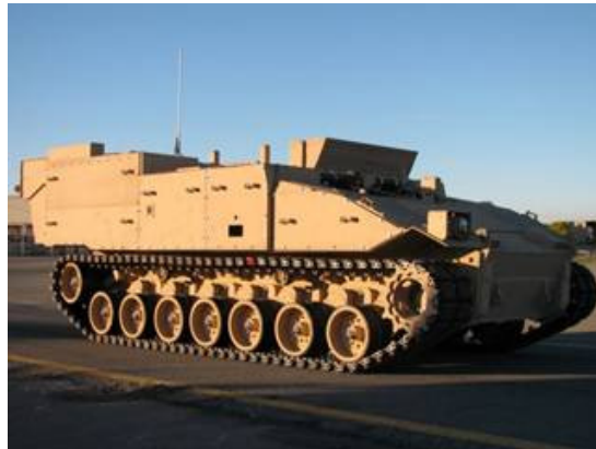
그림 11 미국 육군의 차기 보병전투 장갑차 GCV사업의 일환으로 2,000마일 주행시험을 성공적으로 마무리 지은 BAE시스템사의 하이브리드 전기구동체계
