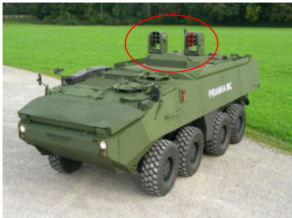
| 그림 21 | LEDS-150을 장착한 Piranha III
