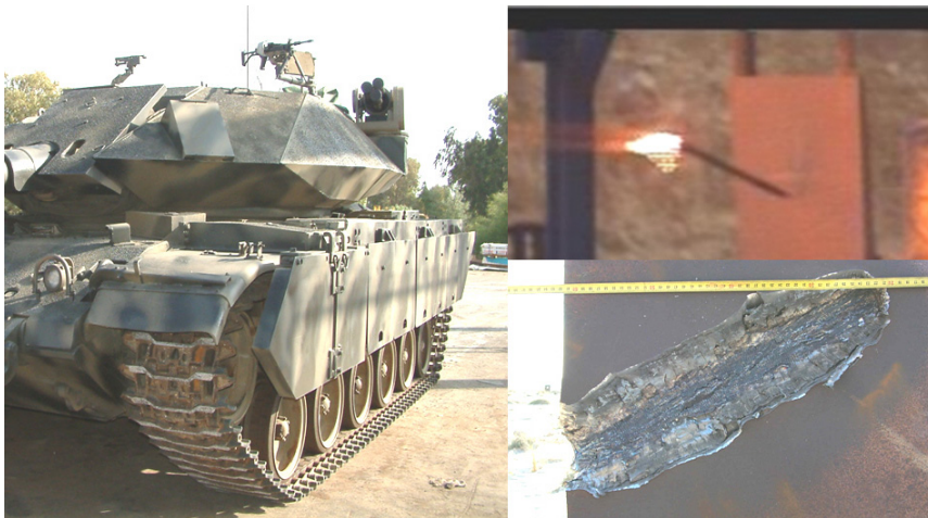
| 그림 16 | Iron Fist가 장착된 M60 Sabra Mk III 주력전차(좌), 운동에너지탄 방호결과(우)
