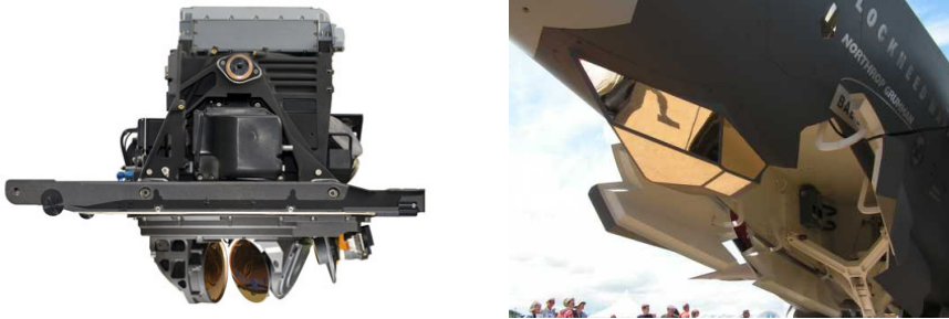
그림 5 | F-35 EOTS AN/AAQ-40(좌)와 F-35의 EOTS 윈도우(우)
