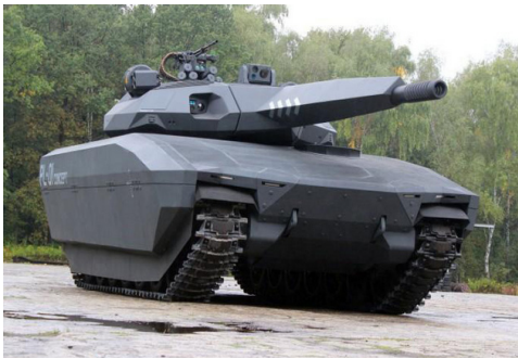
| 그림 10 | 스텔스 형상설계 기술이 적용된 폴란드의 전차 PL-01
