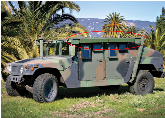
| 그림 24 | TRAPS가 장착된 험비
