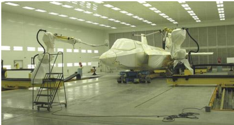
그림 3 | CASPER를 이용해서 F-35에 레이더파 흡수 도료를 코팅하는 모습
