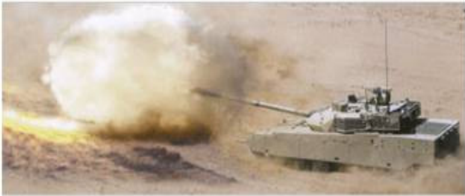
125mm 활강포로 사격하는 MBT-3000의 측면을 보면, 철망형 장갑이 포탑 후면에 부착되어 있으며 포탑 상부에는 12.7mm RWS가 설치되어 있음을 알 수 있다.
