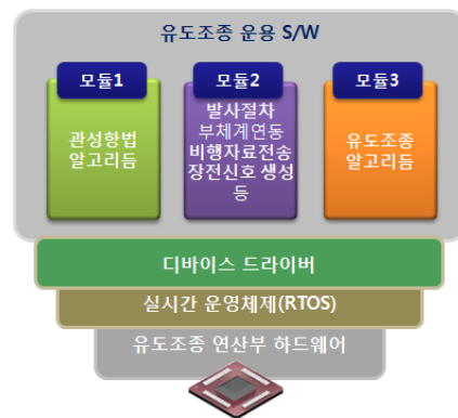
그림 3 | RTOS가 적용된 유도조종장치의 SW 구조
