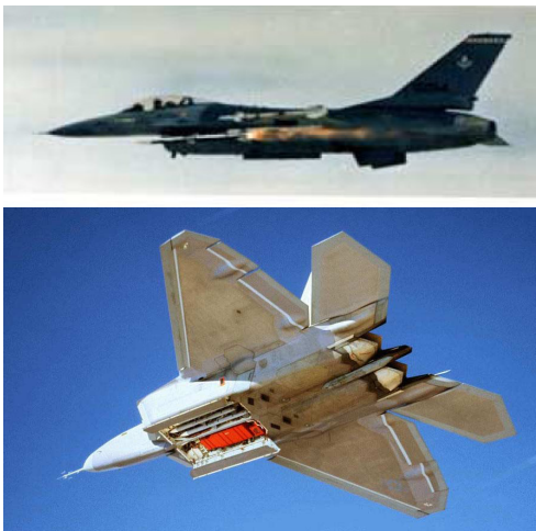
| 그림 9 | Rail 발사대(위)와 Ejection type 발사대(아래)
