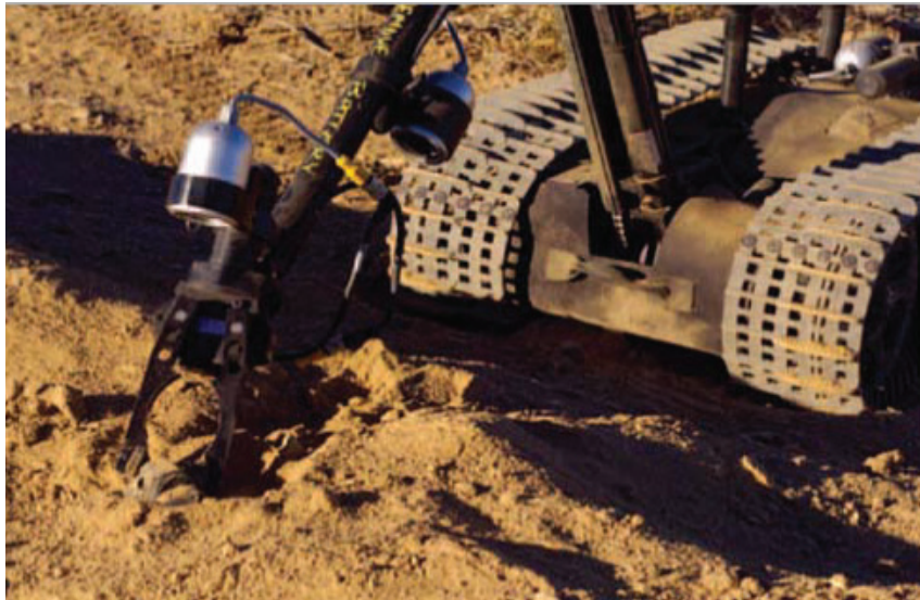
그림 4 모의시험에서 급조폭발물을 수색 중인 Talon 로봇
