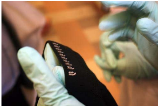
그림 31 땀으로 건강상태를 모니터링하는 팔목 밴드 센서
