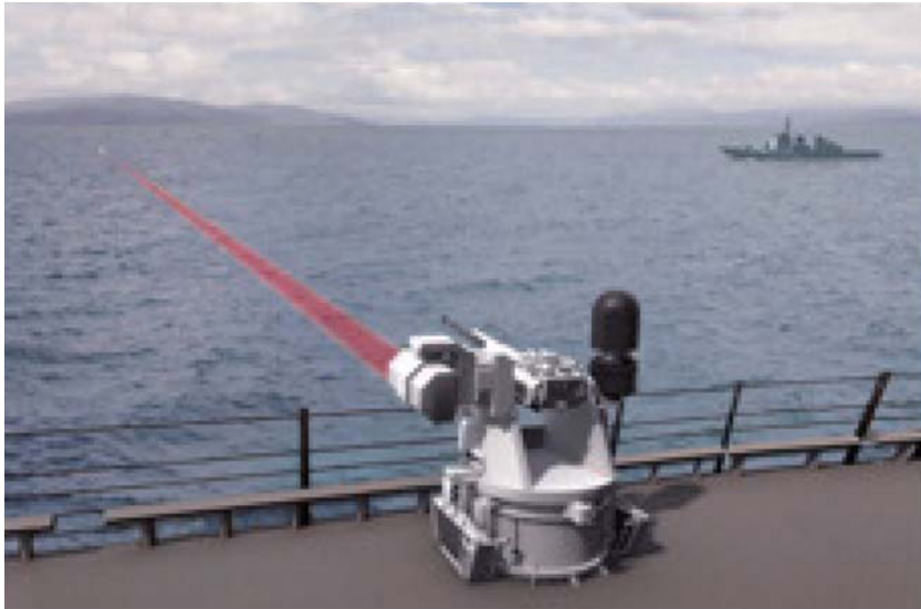
그림 D-1 Mk 38 기관포 마운트에 통합된 TLS 이미지
