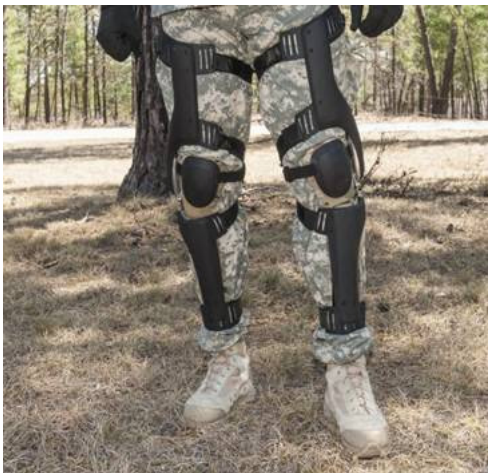
그림 4 | 바이오닉 파워사 무릎 에너지 포집장치 파워워크 M시리즈(PowerWalk M-series)
