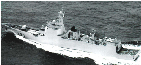
| 그림 3 | 루양 II급 미사일구축함인 2번함 Hikou, 함교구조물 측면에 페이즈드 어레이형 346/348형 다기능 레이더, 후부 마스트의 꼭대기에 야기안테나 형식의 517형 대공레이더를 갖추고 있다. (출처: 잡지 '첨단과기(尖端科技)')
