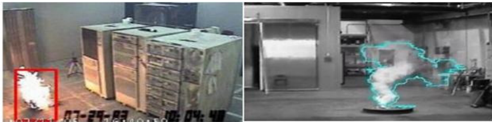
| 그림 15 | 영상화재감지 CCTV의 화염·연기 식별
