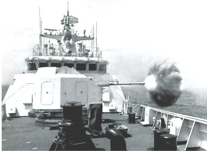
| 그림 1 | 장다오급 초계함 Bengbu의 76mm 함포 발사 장면 (출처: 잡지 '함선지식(舰船知识)')
