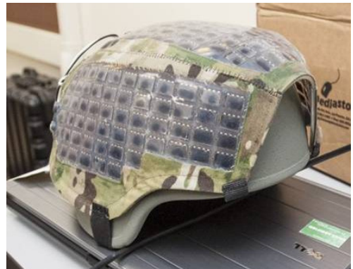
그림 6 | MC-10사의 광전지 태양열 패널 에너지 포집장치(헬멧부착)
