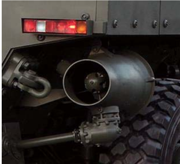
그림 24 | 부메랑은 500마력 터보차지 디젤엔진으로 구동되며, 전(全)륜구동 외에도 상륙작전용 2개 워터제트 추가 추진 방식이다.
