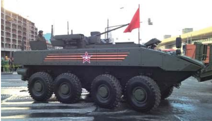
| 그림 27 | 8×8 부메랑은 전(全)륜 구동방식이다. 위 사진은 2개 앞 차축이 조향 차축임을 명확히 보여준다.
