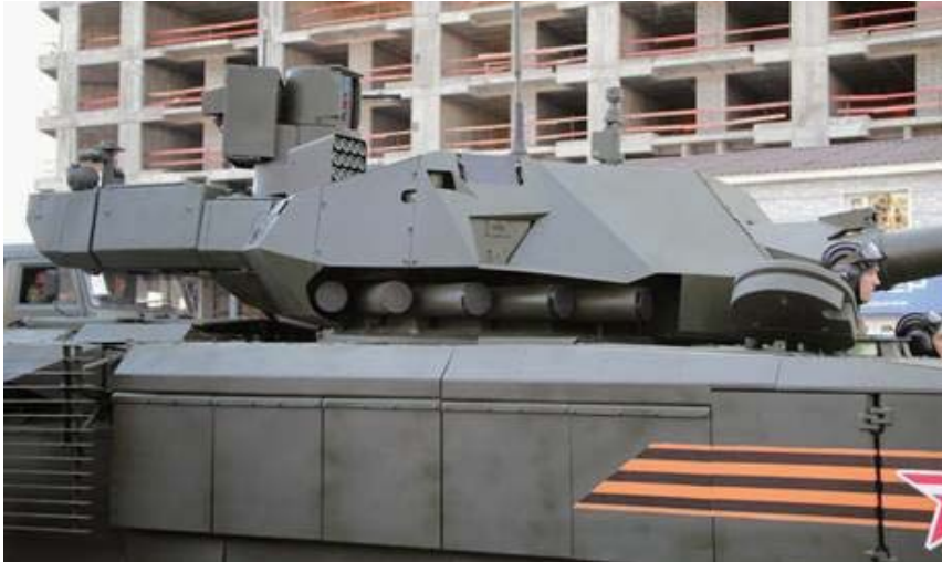
| 그림 8 | T-14는 포탑 양 측면에 능동방어장치 결합체 2조를 장착하고 있다. 탄도방호용 수동장갑으로 덮여 있는 이 모듈들은 아프가니트 센서(사다리꼴 모양), 포탑 기저에 설치된 5개 하드 킬 발사관, 2개 주변감시용 카메라, 평평한(덮여 있을 수 있는) 센서, 소프트 킬 체계와 연계된 것으로 보이는 레이더 등을 통합하고 있다. 일부 소식통에 의하면, 이들 센서는 개발되어 스텔스전투기 수호이(Sukhoi) T-50에 적용한 AESA 레이더 기술을 기반으로 한다. 12개 탄을 포함하는 회전형 소프트 킬 발사기가 회전식 받침대 위에 설치되어 있는 것이 위에 보인다.
