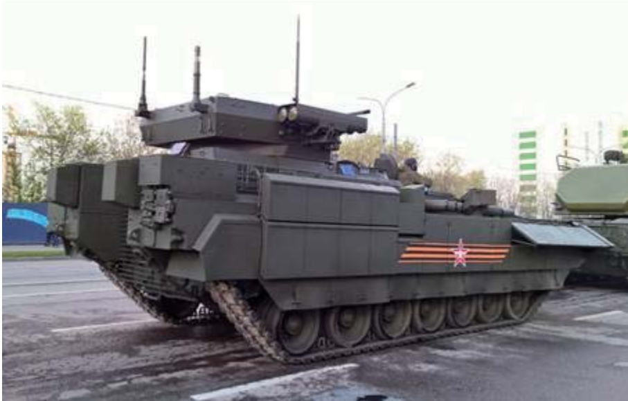
| 그림 6 | T-15 후면으로서 후방 램프 출입문을 방호하는 철망형 장갑 부분을 보여주고 있다.
