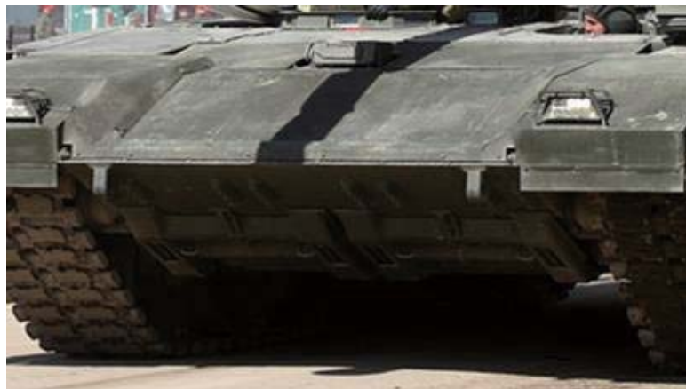
| 그림 3 | 아르마타 플랫폼은 능동지뢰대응체계를 갖추고 있어 전차 앞에 있는 지뢰를 탐지 또는 폭발시키도록 설계되어 있다. 이 체계는 전방 하단에 설치되어 있다.
