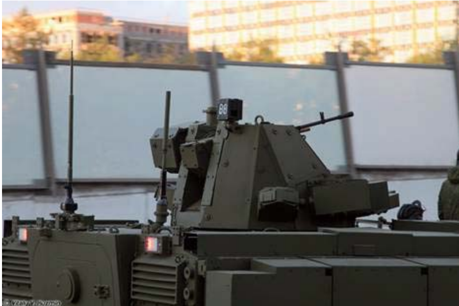
| 그림 19 | 포탑에 설치된 12.7mm 중기관총을 가까이에서 본 모습으로 주야간 신호를 보내는 적외선 투사기가 있다.
