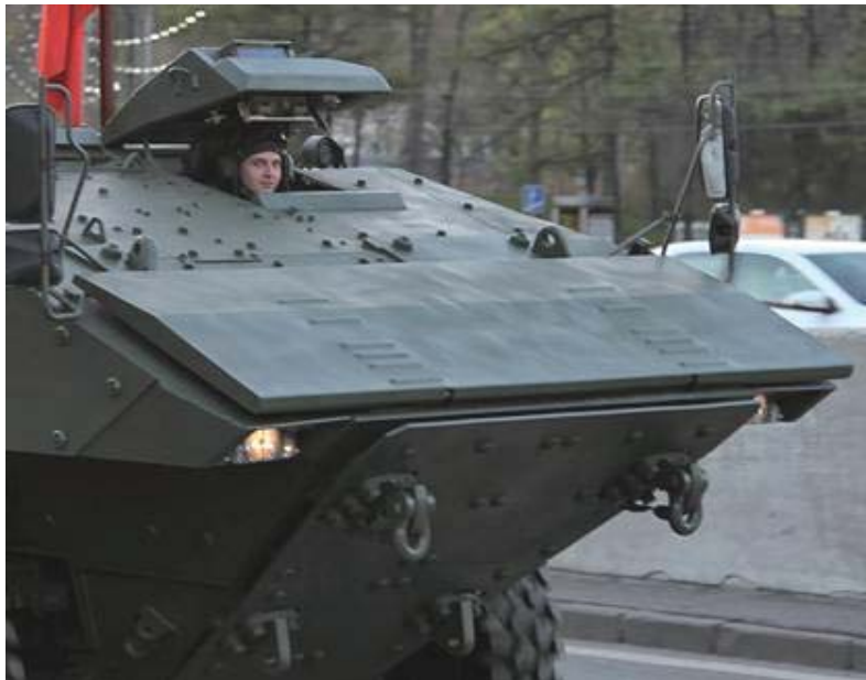
| 그림 26 | 부메랑은 전면에 제파장비를 구비하여, 수상 운용 시 전개한다. 차량 하부에 전면 하부에 보는 바와 같이 장갑판으로도 방호된다.
