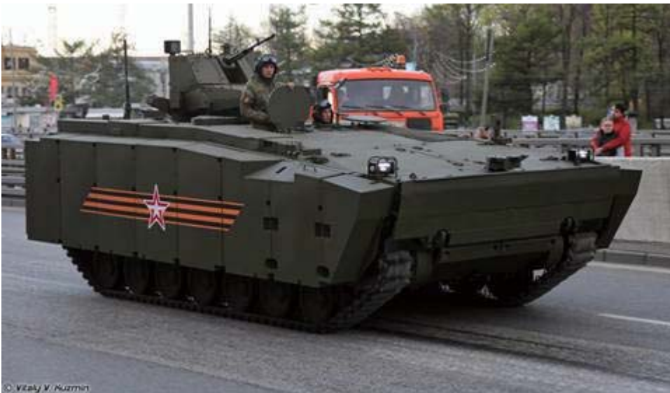
| 그림 18 | 병력수송장갑차 쿠르가네츠-25 BTR(Object 693), 방호된 원격조종포탑을 장착하고 있으며, 여기에 12.7mm 중기관총이 설치되어 있다.
