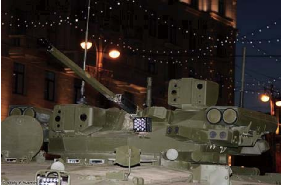
| 그림 15 | EPOCH 포탑을 다른 각도에서 본 모습으로 능동방어장치(소프트 킬)와 적외선 투사기가 보인다.
