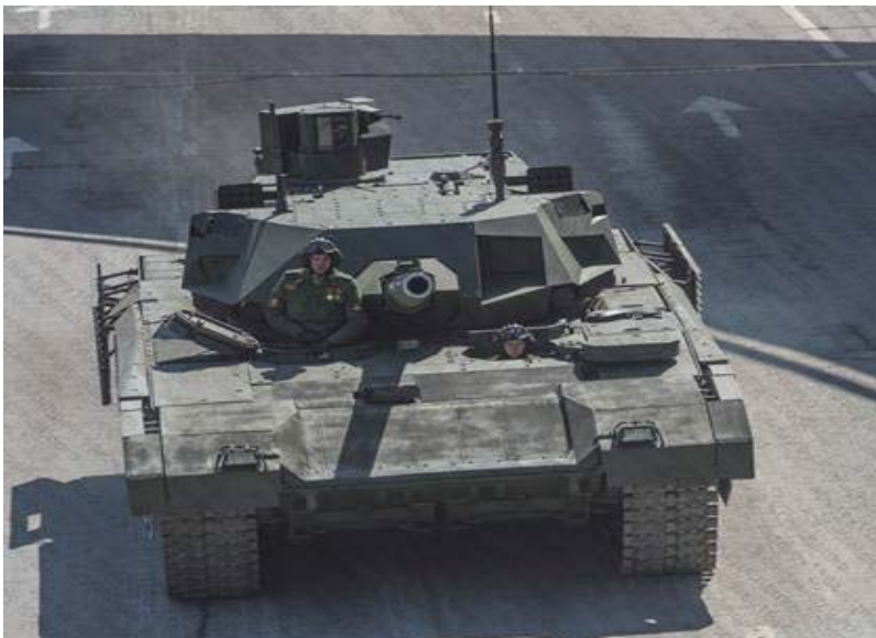
| 그림 9 | T-14의 전면 모습. 조종수 위치에서 비전 블록이나 특별히 눈에 띄는 관측 장비가 없는 것에 주목할 필요가 있다. 해치를 닫았을 때, 조종수는 전차 중앙에 있는 관측체계를 사용할 수도 있으나, 좌석 뒤에 완전한 고정형 잠망경 세트가 설치되어 있다. 2개 전조등은 렌즈 LED를 사용하여, 필요에 따라 가시광선 또는 적외선 조명을 상이한 강도로 제공한다.
