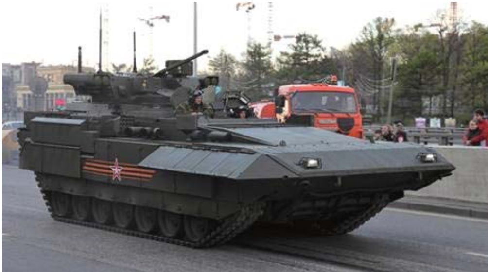
그림 4 | 아르마타 차대에 기반을 두고 있는 신형 T-15 BMP 장갑차 모습으로 전면 하단에 지뢰대응장비가 보인다.
