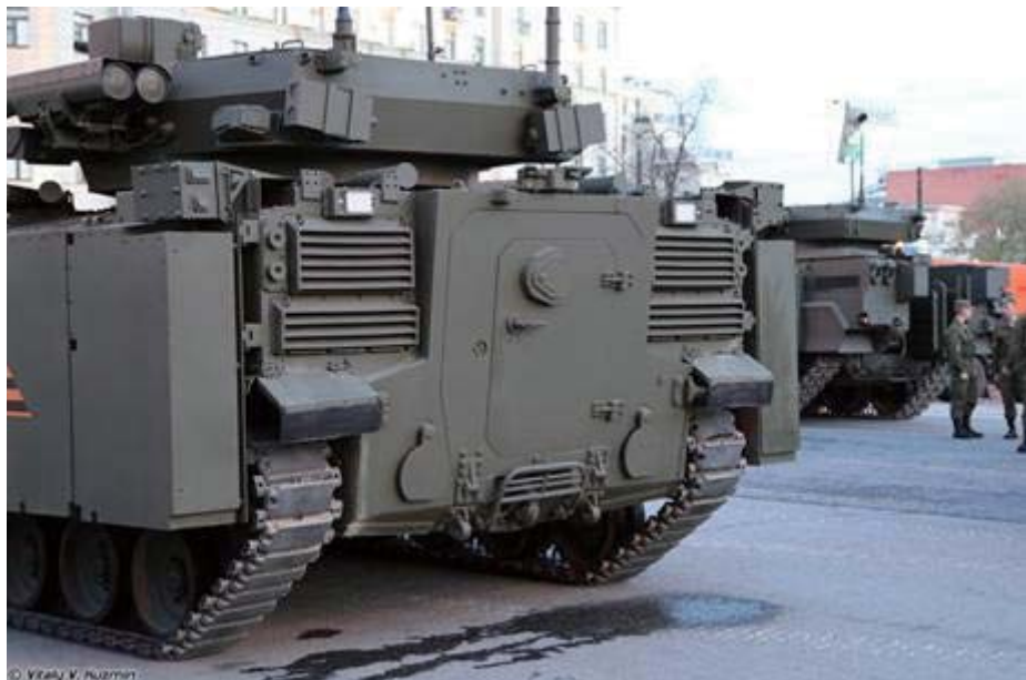
| 그림 16 | 쿠르가네티츠 25 BMP(Object 695)의 뒷모습으로서 접근용 램프, 통합 출입문, 사격용 해치가 보인다. 수상 제트장치의 덮개가 있는 배기관 두 개도 보인다. 또한 하드킬 능동방어장치 아프가니트의 후향 발사장치 4대와 관련 센서가 두 모서리에 보인다. APS 소프트킬 장비가 포탑 후방 모서리에서 보인다.
