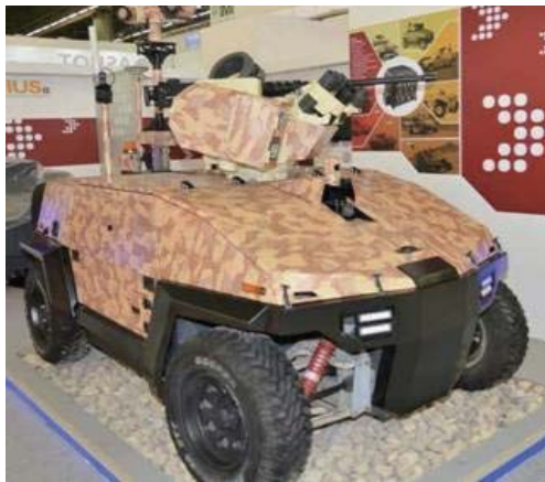
| 그림 8 | 하이브리드 추진체계와 최신 로봇 키트를 갖춘 G-NIUS사 최신 UGV
