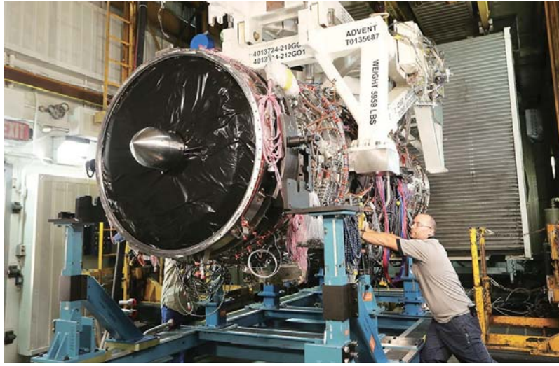
그림 11 GE사와 공군연구소는 2013년부터 2014년 중반에 걸친 작동시험에 이어 2015년 2월에 3중 흐름 ADVENT 시연용 엔진에 대한 상세 검토를 완료하였다.
