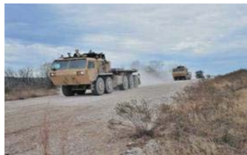
그림 3 | 부가장비를 사용하는 무인기술을 적용하여 자율호송시험 중인 차량
