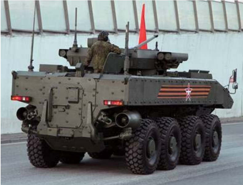
| 그림 25 | BTR-82와 달리 부메랑은 후방 출입램프와 출입문이 있다. 상부 데크에 해치 2개도 있으나 BTR-82와 달리 후방 출입문에 설치된 후방 총안구 이외에는 총안구가 없다. 주변 감시용 카메라 세트(출입문 위에 2개가 보임)를 통해 승무원과 내부 탑승병력에게 상황인식 능력을 제공한다.
