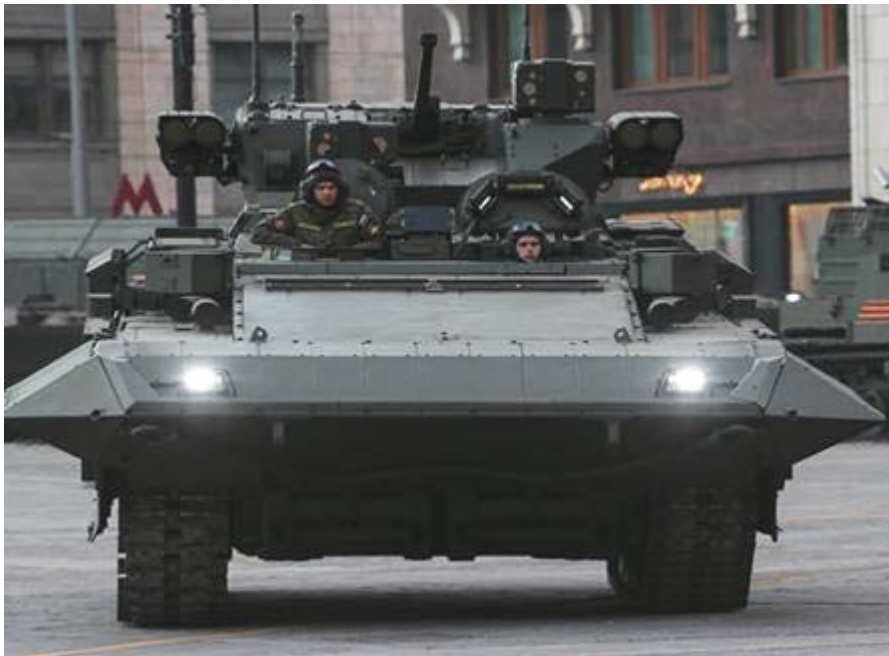
그림 5 | T-15 전면으로서 엔진 배기·흡기장치를 방호하는 외부 스커트를 보여주고 있다.
