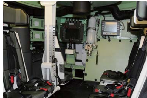
피라냐 5의 내부 모습: 폭발방호 탑승자 좌석 2개, 원격조종무장장치 프로텍터(Protector) OWS를 원격 운영하는 포수 좌석, 맨 좌측에 조종수 좌석
