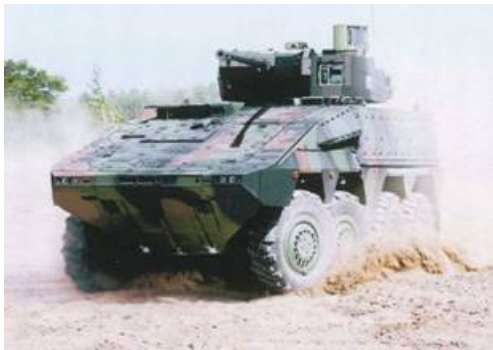
| 그림 4 | RMMV사가 수출용으로 개발한 보병전투장갑차 복서는 랜스(Lance) 포탑을 장착하며, 여기에 마우저 30mm MK 30-2 ABM 이종급탄포 및 7.62mm 동축 기관총과 컴퓨터화한 사통장치를 탑재한다.
