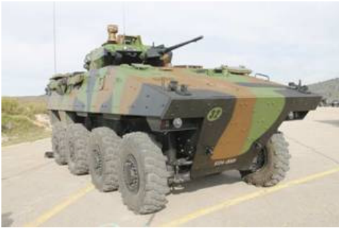
1 그림 21 1인용 포탑을 장착한 프랑스 육군의 보병전투장갑차 VBCI(안정화된 25mm M811포 및 7.62mm 동축기관총 탑재)
