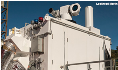
| 그림 1 | 이러한 청색 빔을 결합하는 장비처럼 록히드마틴사의 30kW 광섬유레이저는 다수의 별도로 된 광섬유와 상이한 파장을 자유공간 결합체로 결합하여 하나의 스펙트럼으로 결합된 빔을 만든다. 대부분의 HEL은 보이지 않는 IR 영역에 있다.
