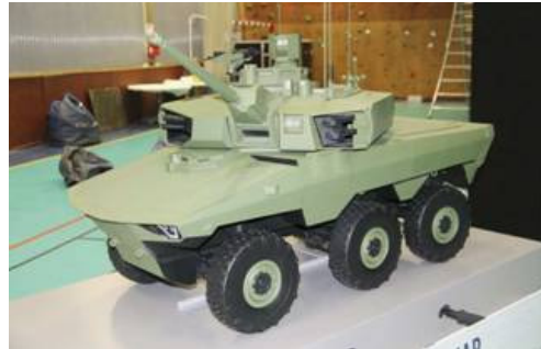
그림 3 | 2인용 포탑 장착된 EBRC 최신 축소모형 (40mm CTAS, 7.62mm 기관총, ATGW 무장)
