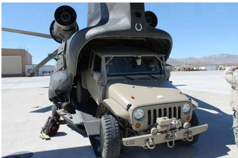
| 그림 9 | CH-47 헬기 내부 적재 뿐 아니라 슬링 공수도 가능하게 설계된 코만도 지프
