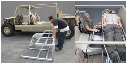
| 그림 8 | 의무후송임무용으로 들것 두 개를 탑재한 바이퍼 다이내믹스사 POD 프레임
