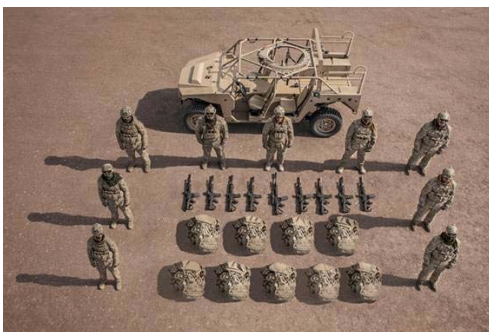
| 그림 1 | 완전군장병사 9명을 수송하도록 설계되어 5대로 1개 소대병력 수송 가능한 DAGOR
