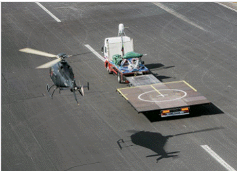
영국 국방부의 CCD 사업에 대한 2단계(일련의 모의갑판 착륙시험 포함) 시험을 실시하고 있는 아구스타웨스트랜드사의 SW-4 RWUAS
