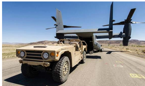
| 그림 5 | SOCOM의 ITV(Internally Transported Vehicle) 요구사항을 충족시키기 위한 특별 주문제작형 팬텀 배저
