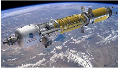
| 그림 1 | 지구 저궤도(LEO)에 있는 바이모달 핵열 로켓(Bimodal Nuclear Thermal Rocket) 개념도
